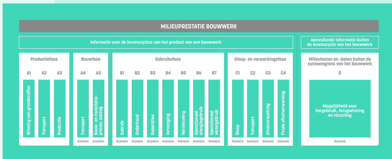
Figuur 2 Voor bouwwerken worden de volgende LCA-fases onderscheiden
